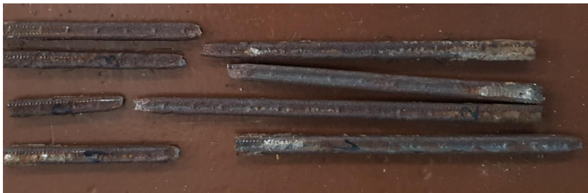
Obr. 11: Vzorky betonářské oceli po zkoušce v tahu
