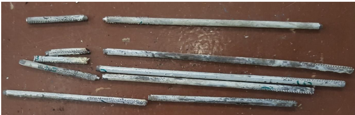
Obr. 13: Vzorky předpínací výztuže po zkoušce v tahu
