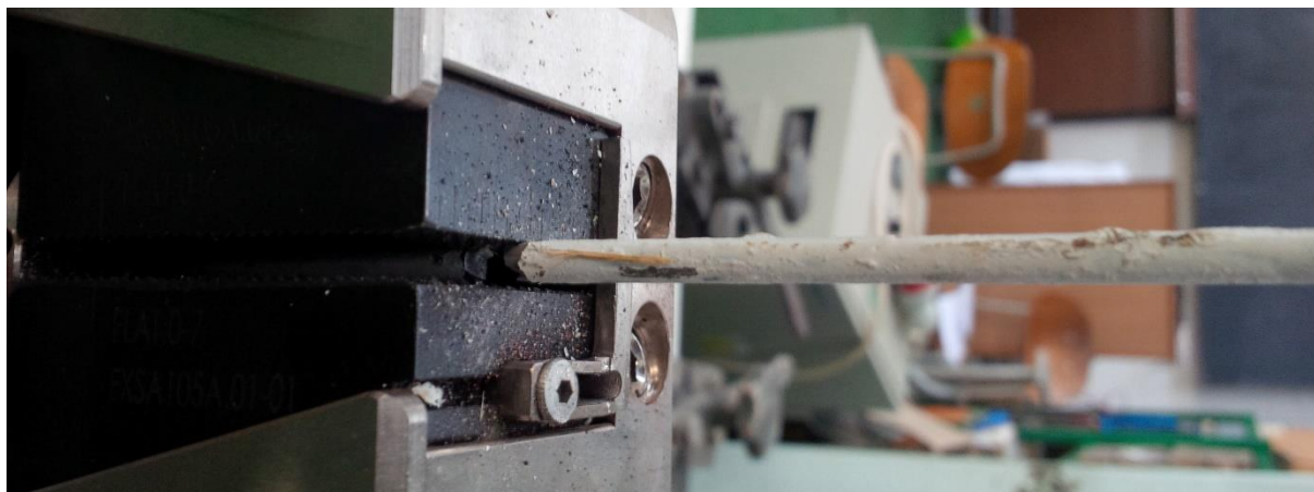
Obr. P20: Pevnost předpínací výztuže v tahu - vzorek Pv3 po zkoušce
