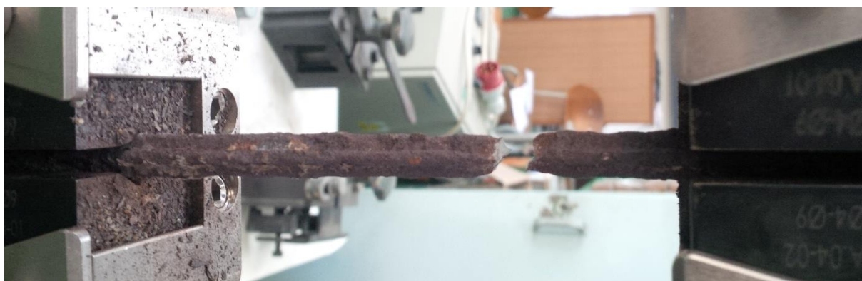
Obr. P12: Pevnost betonářské výztuže v tahu - vzorek Bv3 po zkoušce
