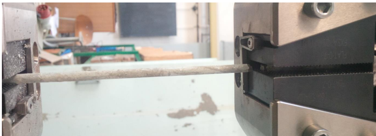
Obr. P24: Pevnost předpínací výztuže v tahu - vzorek Pv5 po zkoušce
