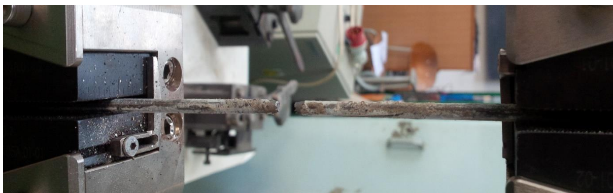
Obr. P16: Pevnost předpínací výztuže v tahu - vzorek Pv1 po zkoušce
