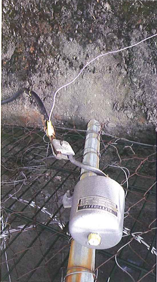
Obr. 12 Měření na obnažené výztuži na NK
