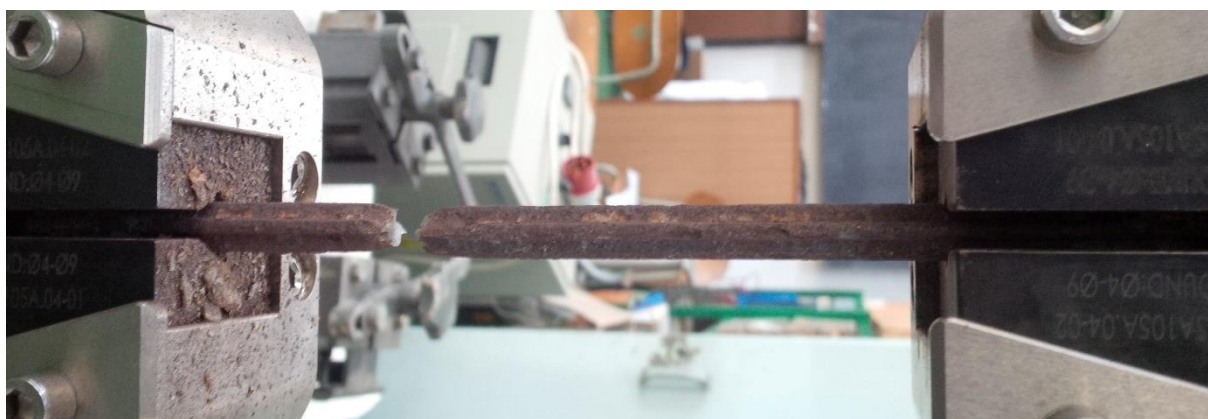
Obr. P8: Pevnost betonářské výztuže v tahu - vzorek Bv1 po zkoušce
