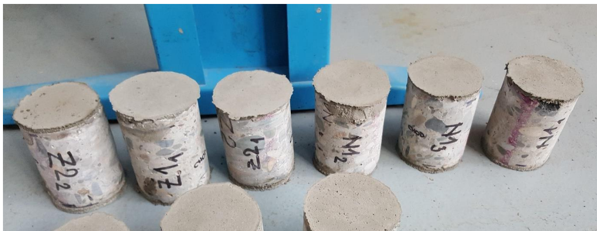
Obr. 4: Odebrané a zakoncované jádrové vývrtky pro zkoušku betonu v tlaku
