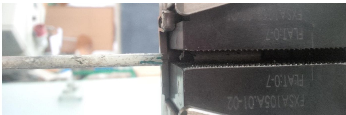
Obr. P22: Pevnost předpínací výztuže v tahu - vzorek Pv4 po zkoušce
