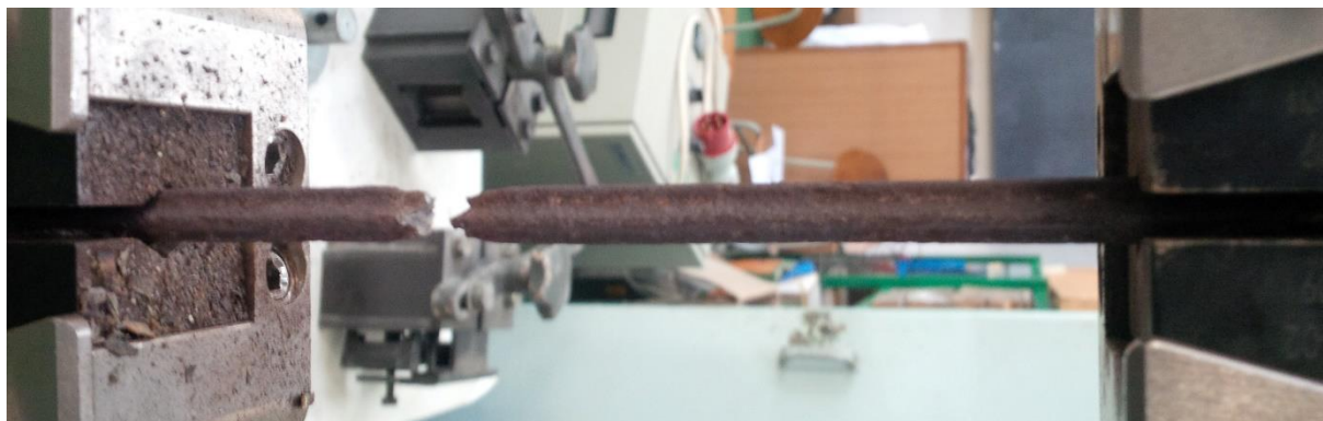
Obr. P14: Pevnost betonářské výztuže v tahu - vzorek Bv4 po zkoušce
