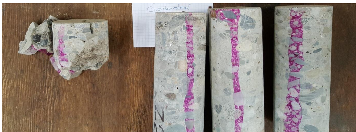
Obr. 6: Zjišťování úrovně karbonatace betonu
