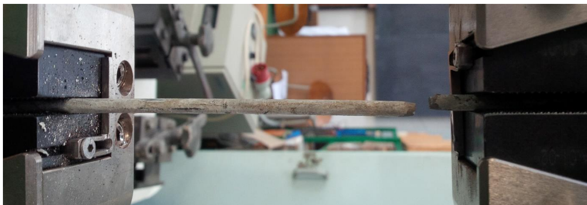
Obr. P18: Pevnost předpínací výztuže v tahu - vzorek Pv2 po zkoušce
